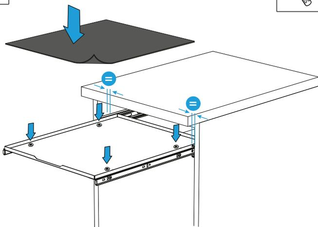
Отрегулируйте крышку и зафиксируйте его винтами к направляющей.
