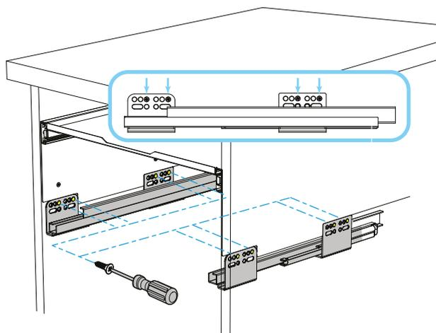
Установите нижние направляющие C, согласно разметке (шаблона).
