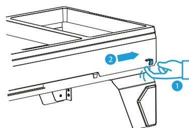
Нажмите на металлические фиксаторы, чтобы снять боковины с направляющих.
