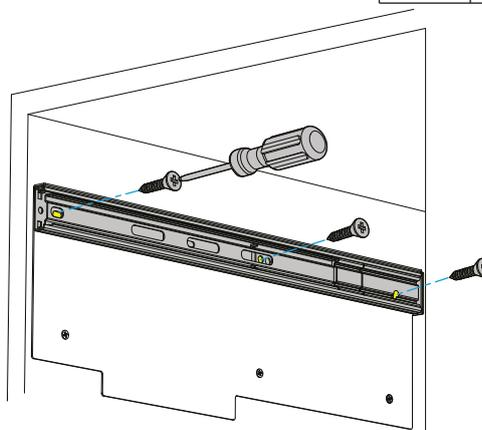
Произведите фиксацию внешней части направляющей к боковой стенке корпуса (в верхней части пластины А).
