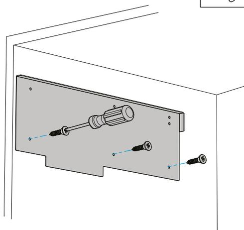
Зафиксируйте металлические пластины А саморезами.
